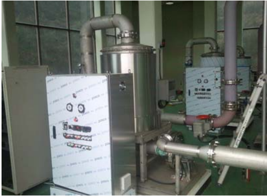
催化臭氧分解装置 (35~55 °C) (流入 2,000 ppm, 排放 \leq 0.06 ppm)
