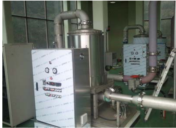
촉매식 오존분해장치 (35~55 °C) (인입 2,000 ppm, 배출 ≤ 0.06 ppm)
